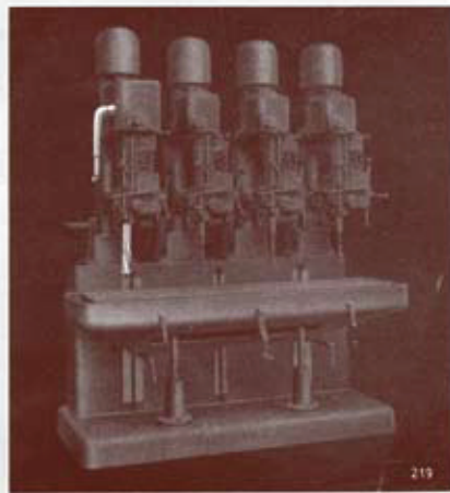
Bild 219. 4spindl. Reihenbohrmaschine bestehend aus 3 Spindeln S 56 PA 8 und 1 Spindel S 56 PA 8 G.
